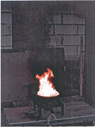
Foto 1: Innesco dell'olio test 2
